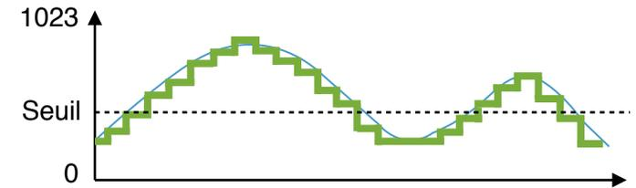
Le capteur communique une tension en volt proportionnelle au lux : plus il y a de lumière (lux) plus le capteur communique de volt (entre 0 et 5v). Cette valeur analogique est ensuite convertie en numérique directement dans scratch. Le signal est donc numérisé.
