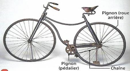
**2** Cette bicyclette en acier (environ 20 kg) utilise le principe technique « chaîne pignons ». Ce système transmet la force du pédalage vers la roue arrière.
