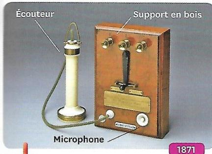
Le téléphone est une **invention** dont le **principe technique** repose sur la conversion des signaux sonores en signaux électriques (et inversement). Il a connu une **évolution technologique** qui a permis de mieux répondre aux besoins des utilisateurs. Ces **innovations** se traduisent par exemple par l'ajout de nouvelles pièces, appelés **constituants**.
